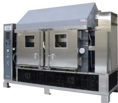
腐食促進試験装置
