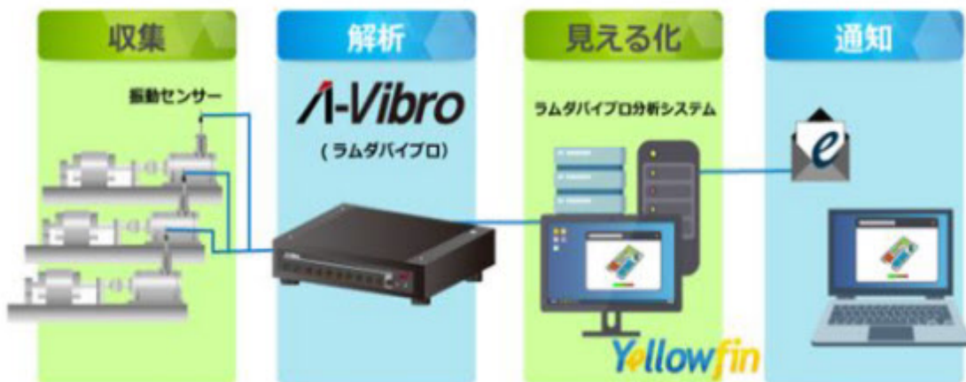
「ラムダバイブロ分析システム」による故障の早期発見イメージ
