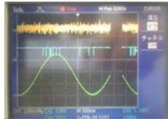
(例)材料の放電状況カウント波形
