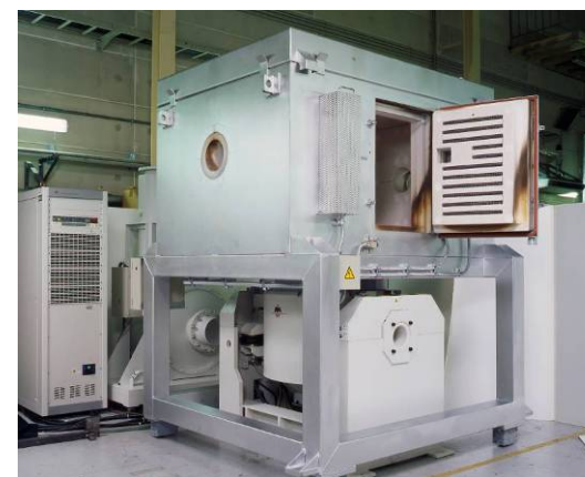
オールウェザーシミュレーター(電気炉複合) (平成18年3月発売)
