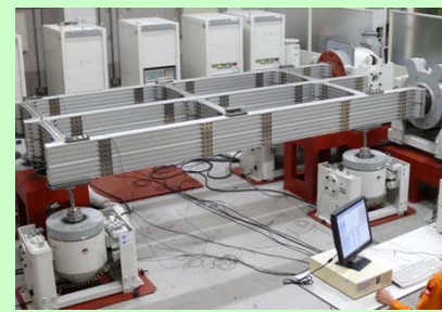
多点制御試験設備
