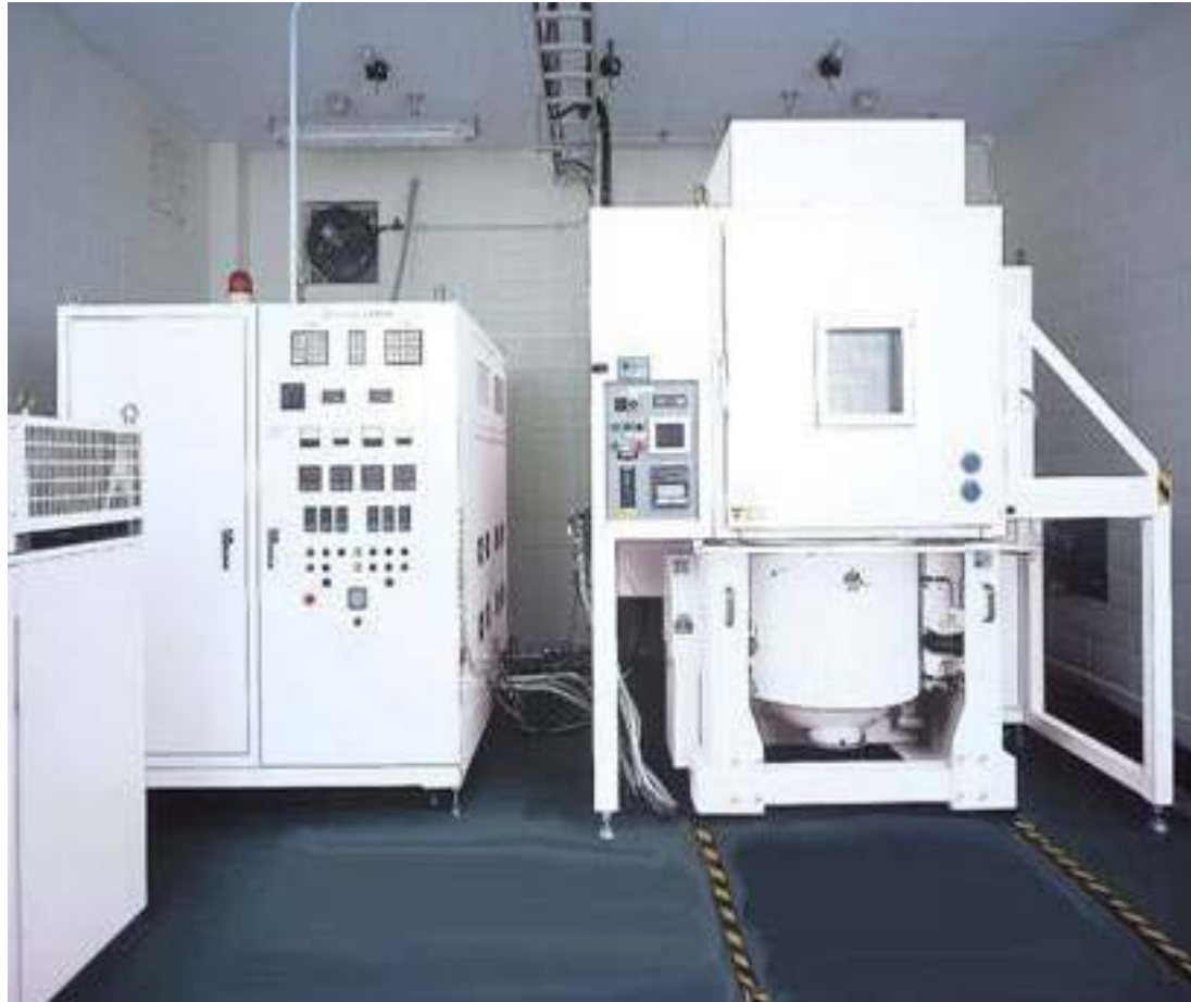
オールウェザーシミュレーター (振動・温度・湿度・作動装置)
