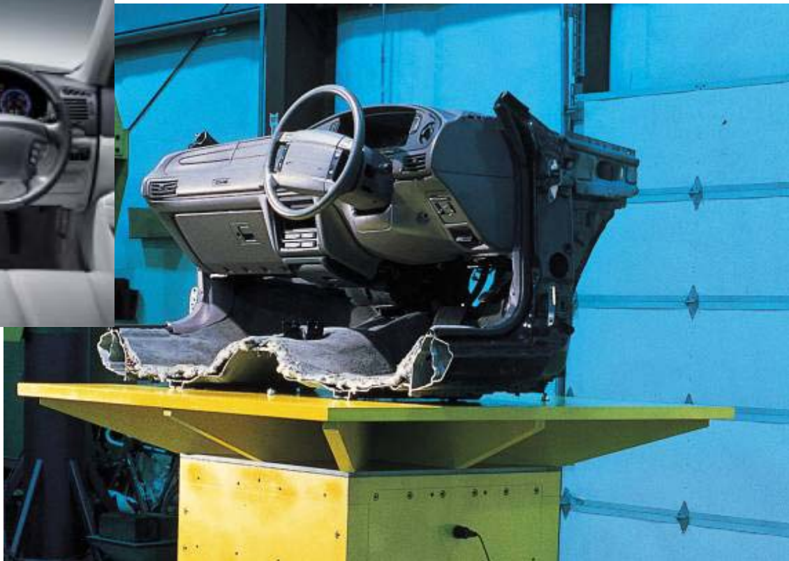
試験風景 (スクウィーク&ラトル試験)
