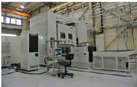
e-TCJではモーター、インバーターの環境試験、及びEMC試験で総合的なEV関連の評価が可能。ワンストップの利便性で受注伸ばす
