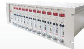
接触式振動監視装置
