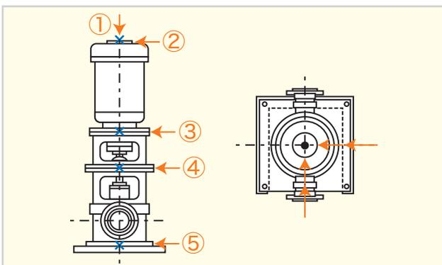
縦型機械の測定箇所
