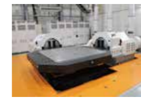
Le plus grand système de test de vibration de 350 kN au monde avec table horizontale
