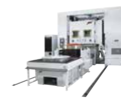
Kammer kombiniert mit einem Schwingprüfsystem mit Gleittisch
