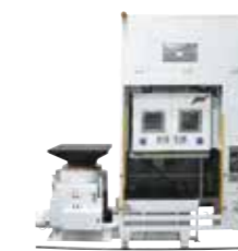
Kammer kombiniert mit einem Schwingprüfsystem mit Gleittisch
