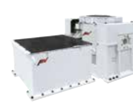
Das weltweit größte 350 kN Schwingprüfsystem mit einem Gleittisch
