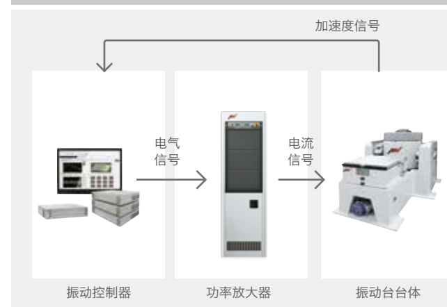
一般的振动试验装置的信号流程图
