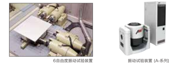
6自由度振动试验装置
