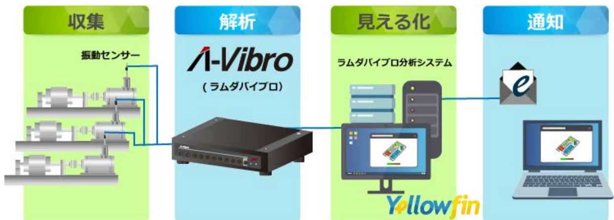
「ラムダバイプロ分析システム」による故障の早期発見イメージ
