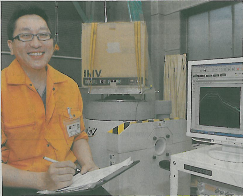
みや・まさのり 群馬県出身。千葉大卒業後、半導体装置メーカーなどを経て03年にI-MV（大阪市）に。同社は国内最大手の振動試験機メーカー。東京、名古屋、大阪の3拠点で受託試験もする。奥にあるのが振動試験機。試験ではモニターを見ながらパソコンに様々な数値を入力し、揺れをあやつる。 ＝相模原市緑区、伊藤圭撮影
