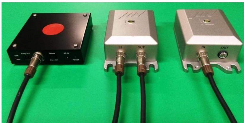
⑤HM-0013用USB変換ボックスの電源ジャックにUSB-DC電源ケーブル及びACアダプタを接続してください。
