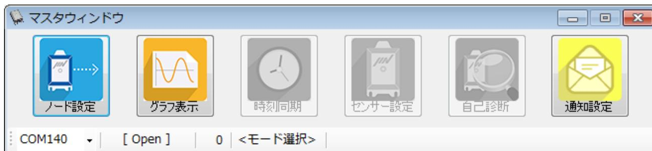
複数のノード（HM-0013-M/HM-0013-E）が接続され、データの収録、収録データの波形表示、ファイル保存などを行ないます。プログラム起動時に、マスターウィンドウ1個と、設定されているノードの数分のノードウィンドウが展開されます。
