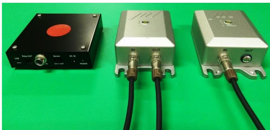
④HM-0013用USB変換ボックスの専用ノード端子に専用ケーブルの反対側を接続してください。
