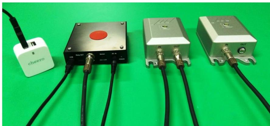
⑦最後にACアダプタをAC電源に接続し、microUSBケーブルをパソコンに接続してください。
