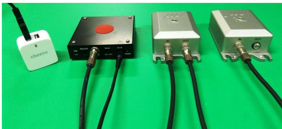
⑥HM-0013用USB変換ボックスのmicroUSB端子にmicroUSBケーブルを接続してください。
